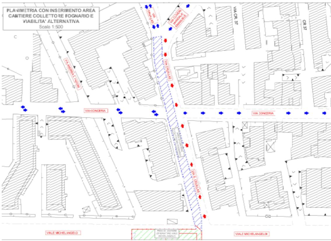
La Società MANELLI IMPRESA S.p.A., dovrà apporre, la segnaletica stradale di preavviso lungo Viale Michelangelo e Via Santuario di Cruillas, con appositi segnali di cantiere indicante l'istituzione del senso unico di marcia, nei tratti stradale interessati dai lavori.
